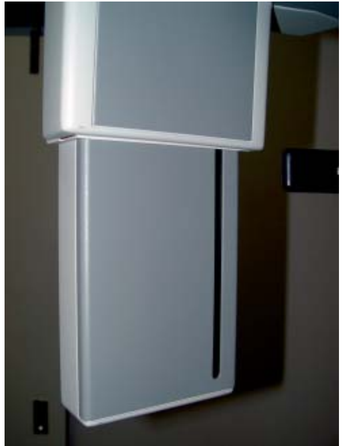
Fig. 4- Área ativa do sensor sólido extraoral do sistema digital Instrumentarium OP 100 D.
