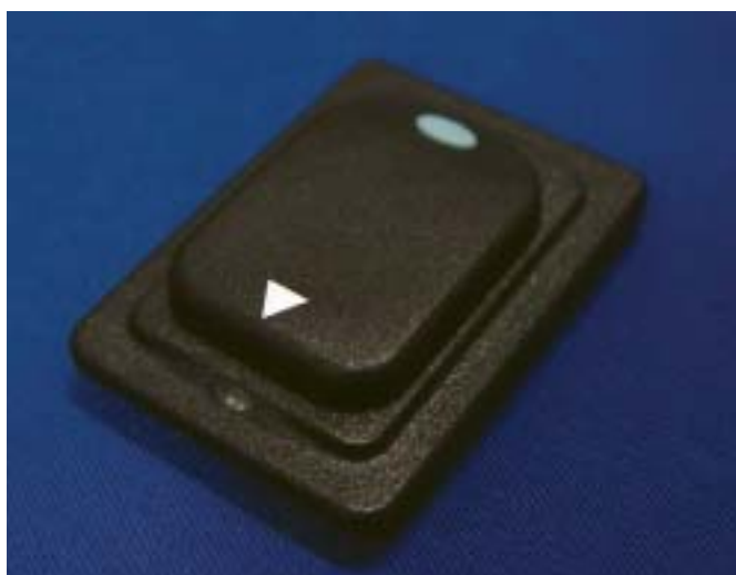
Fig. 6- Vista posterior do sensor sólido do sistema Schick CDR Wireless com bateria acoplada.
